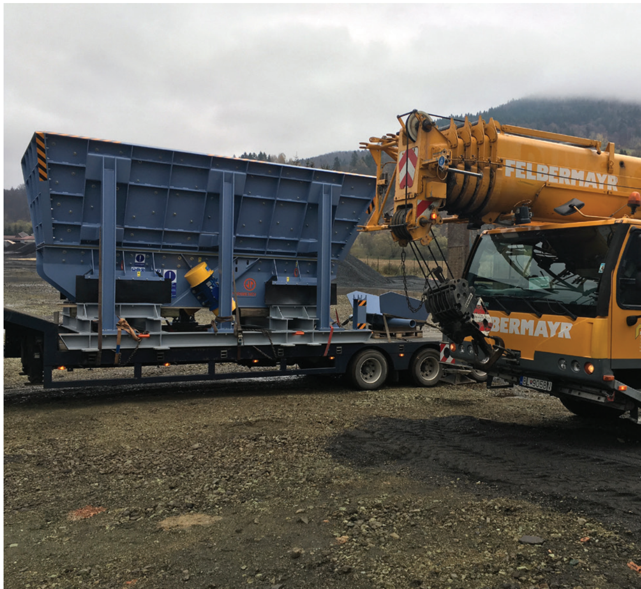
Podajnik wibracyjny VPF 1050, z lejem wspanym 15 m 3
